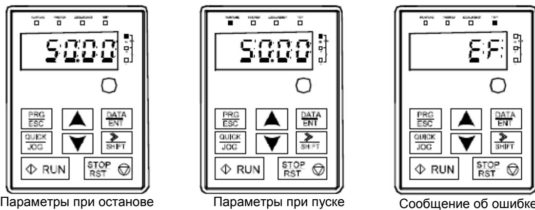
Рис.6-2 Отображение состояния на дисплее
